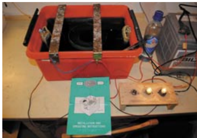
Over: Nikkelsettet opprigga og i drift.
